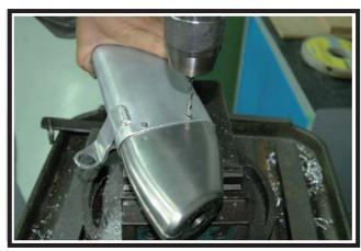
Die neue Schalldämpferendkappe des Kits montieren.
