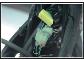
Stecker mit dem Kabelschutz abdecken.
